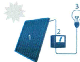
1 Zonnepaneel | 2 Omvormer | 3 Elektrische toestellen
